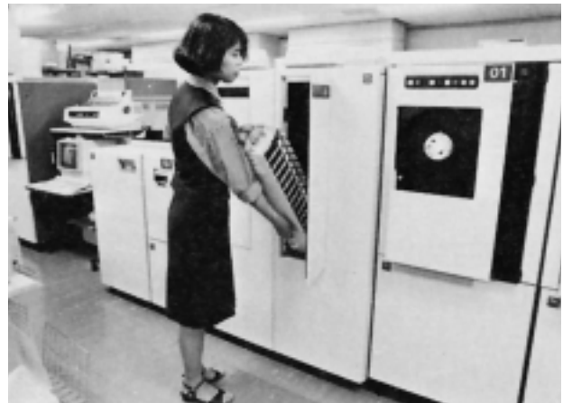
写真3 磁気テープ装置 〔オートチェンジャー式〕
